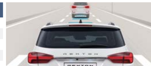
ESS – automatyczne włączanie świateł awaryjnych
